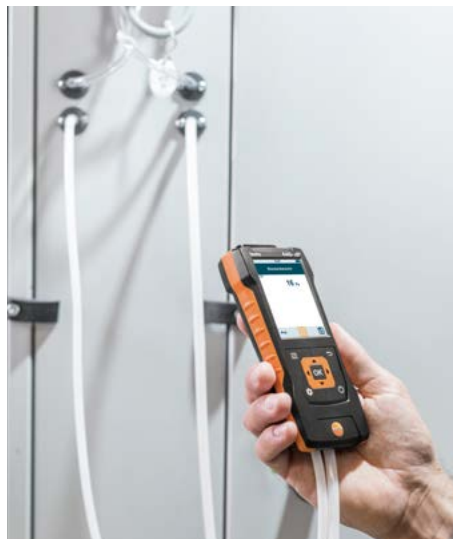
Mit dem Modell testo 440 dP inkl. Differenzdruck-Sensor stellen Sie sicher, dass die Filter von Klimaanlage ordnungsgemäß funktionieren und kein Schmutz der Außenluft in die Raumluft gelangt.
