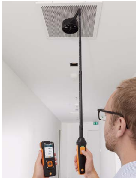
Die 100 mm-Flügelrad-Sonde kann ganz bequem mit dem 90°-Winkel plus Teleskop verbunden werden. Das vereinfacht Messungen an Deckenauslässen.
