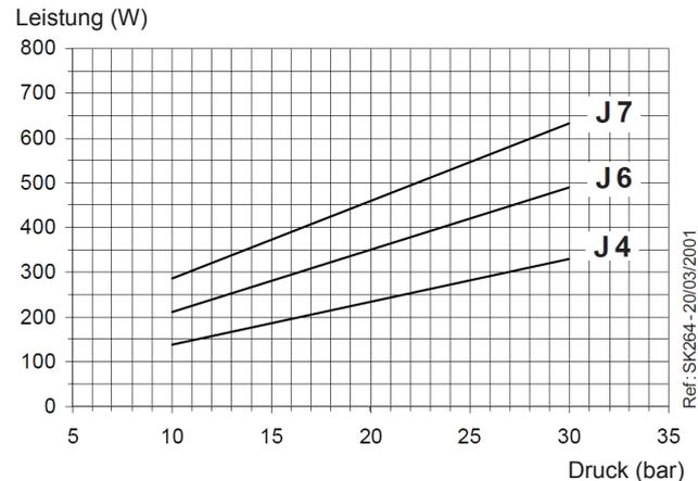
Viskosität = 5 cSt - Pumpendrehzahl = 2850 U/min
