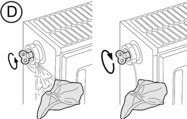
Abb. 20: Manueller Entlüfter D der Heizkörper
