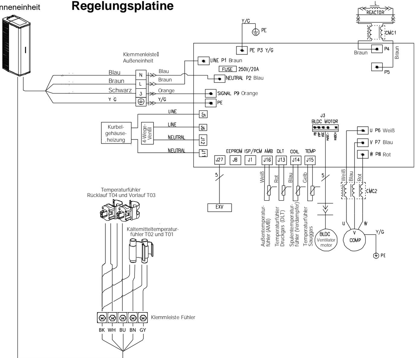
Abb. 32: Schaltplan Außeneinheit
