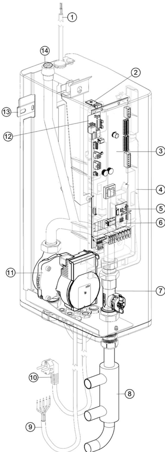
Abb. 1: Hauptkomponenten Inneneinheit
