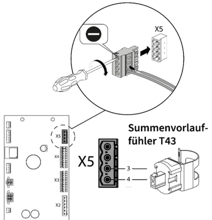
Abb. 29: Anschluss des Summenvorlauffühlers T43
