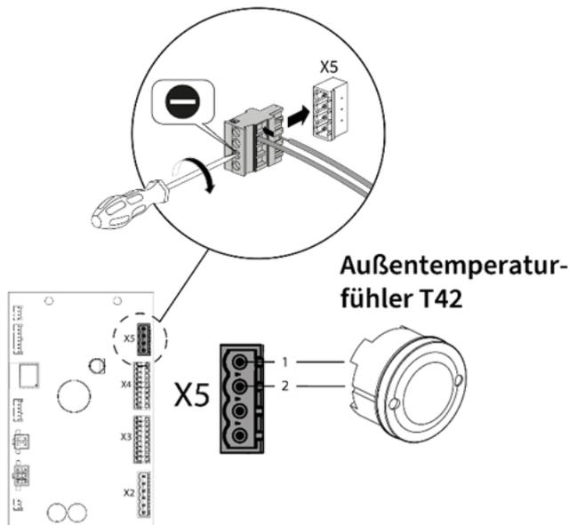
Abb. 28: Anschluss des externen Außentemperaturfühlers
