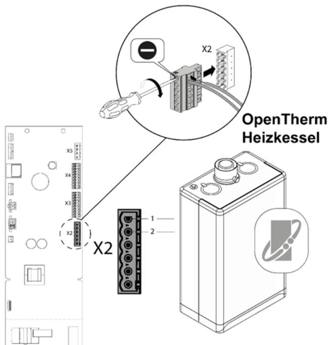
Abb. 26: Anschluss eines OpenTherm-Heizkessels
