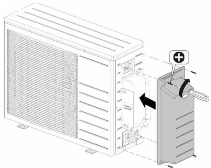
Abb. 25: Montage der Seitenverkleidung
