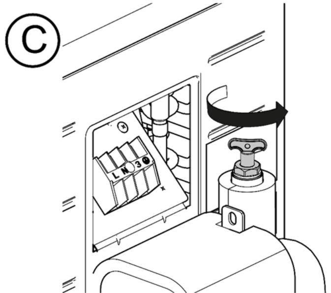
Abb. 48: Manueller Entlüfter **B** der Außeneinheit
