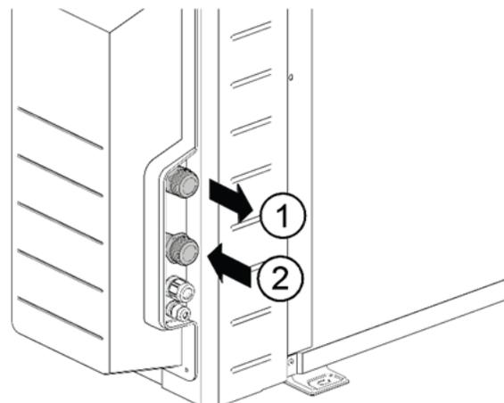
Abb. 16: Anschlüsse der Außeneinheit
