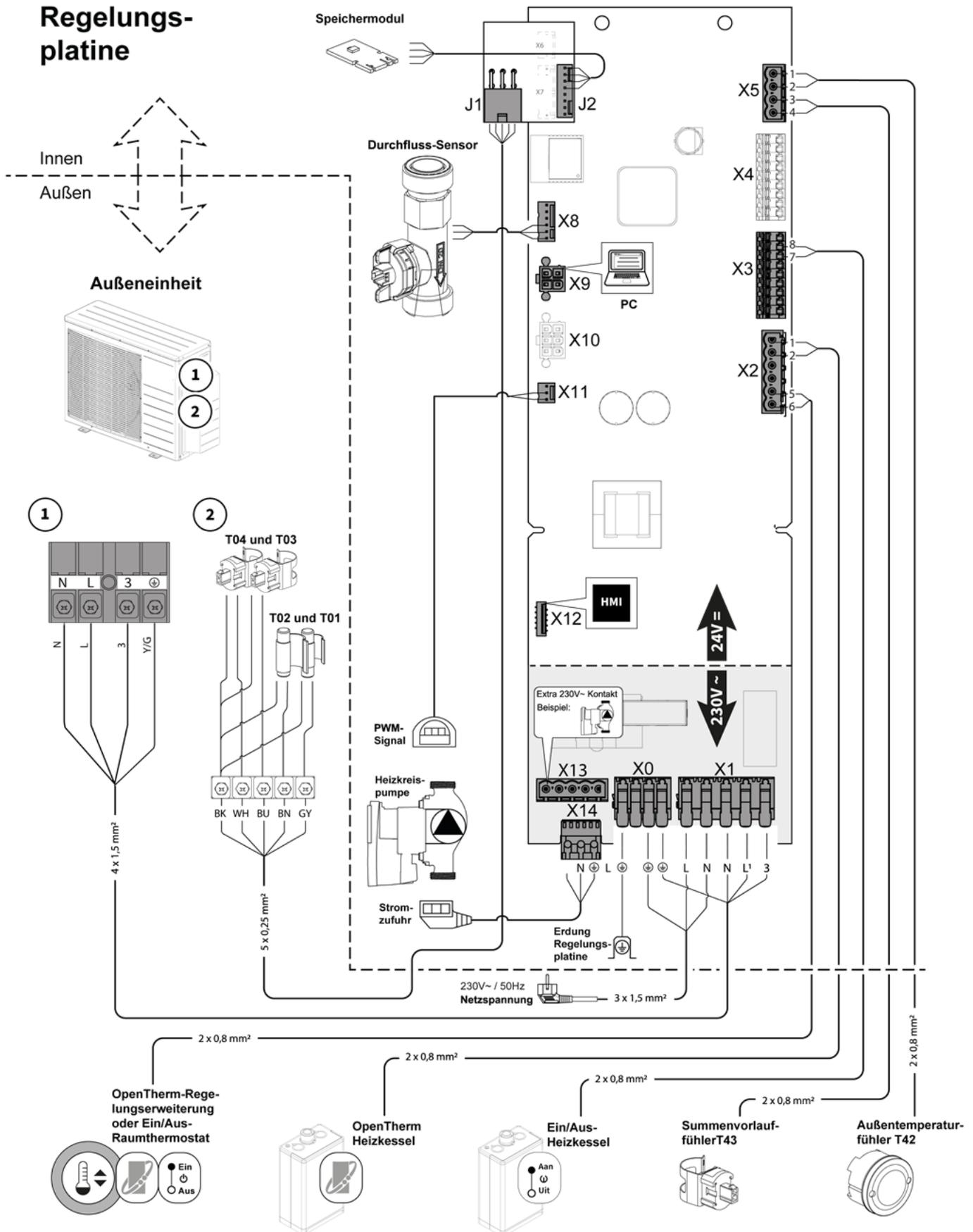
Abb. 33: Elektrischer Schaltplan Inneneinheit
