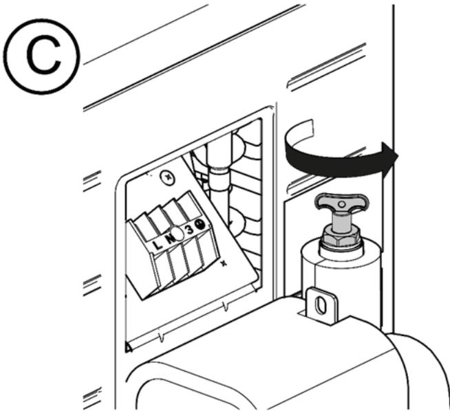
Abb. 19: Manueller Entlüfter © der Außeneinheit
