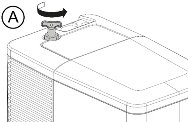
Abb. 46: Manueller Entlüfter **A** der Inneneinheit
