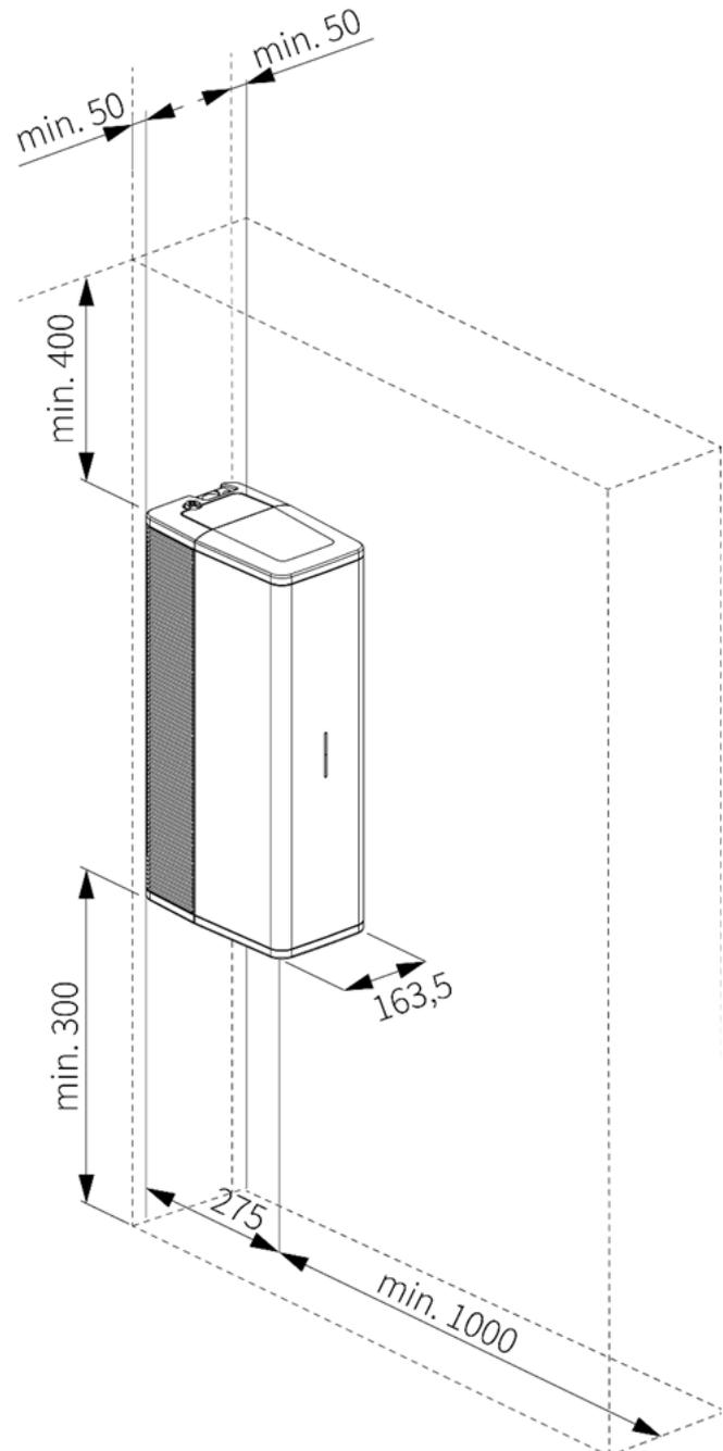
Abb. 3: Abmessungen Inneneinheit
