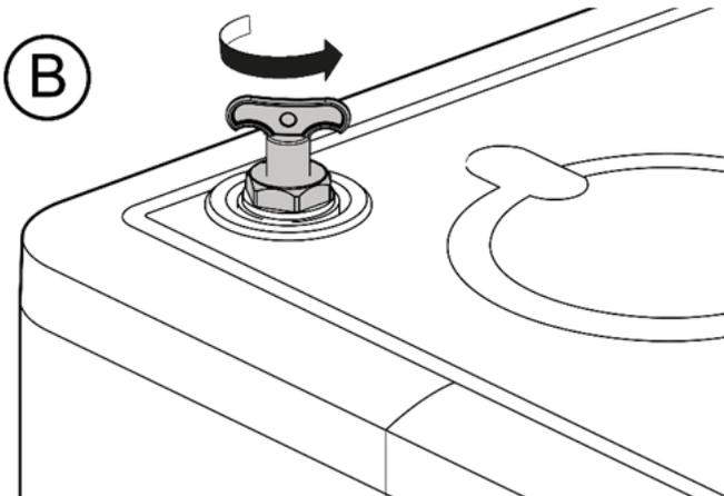
Abb. 47: Manueller Entlüfter **C** des Heizkessels
