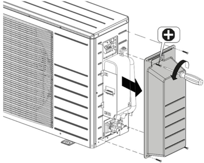
Abb. 15: Demontage Seitenverkleidung
