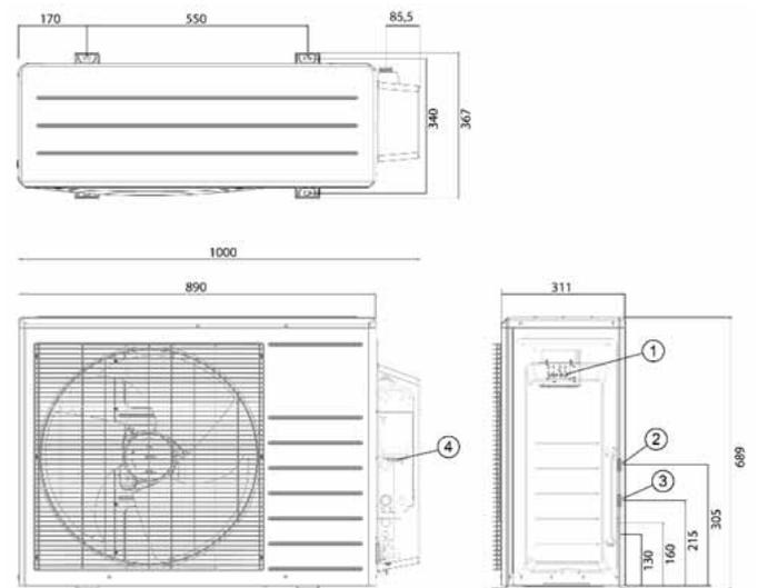
Abb. 6: Abmessungen und Anschlüsse Außeneinheit
