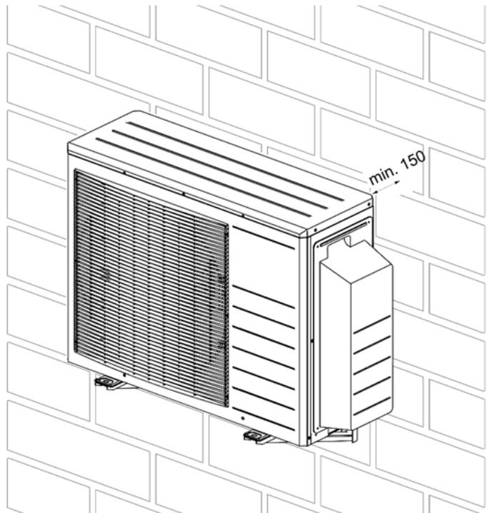
Abb. 8: Mindestabstand zwischen Außeneinheit und Wand in mm
