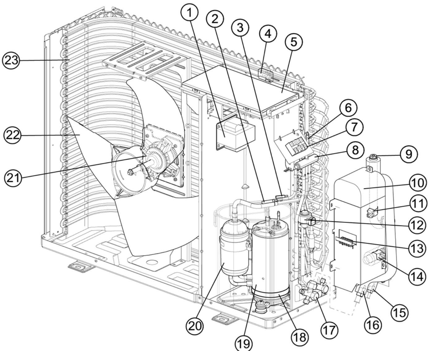
Abb. 2: Hauptkomponenten Außeneinheit
