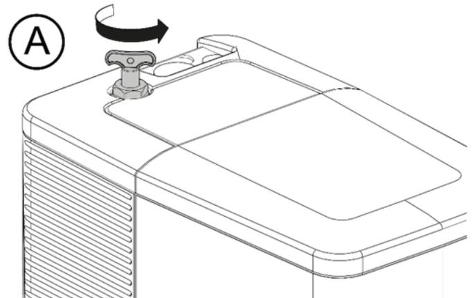
Abb. 17: Manueller Entlüfter (A) der Inneneinheit
