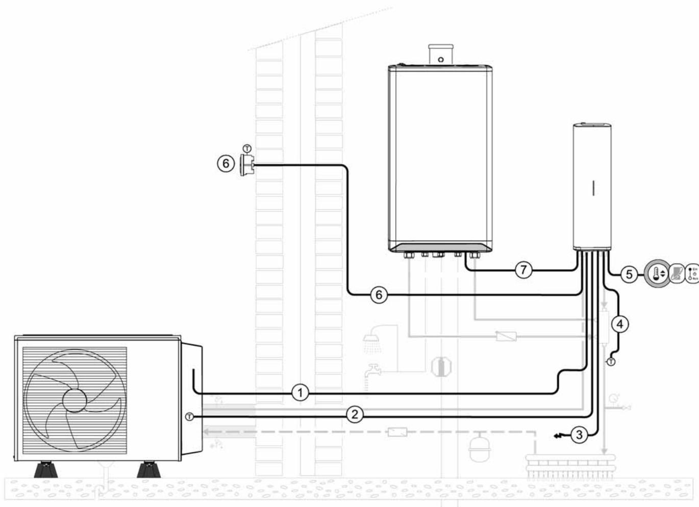
Abb. 31: Elektrische Installationsübersicht
