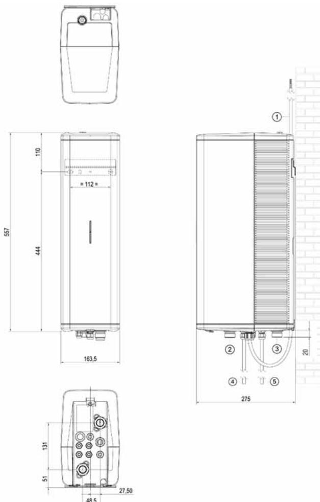
Abb. 5: Abmessungen und Anschlüsse Inneneinheit
