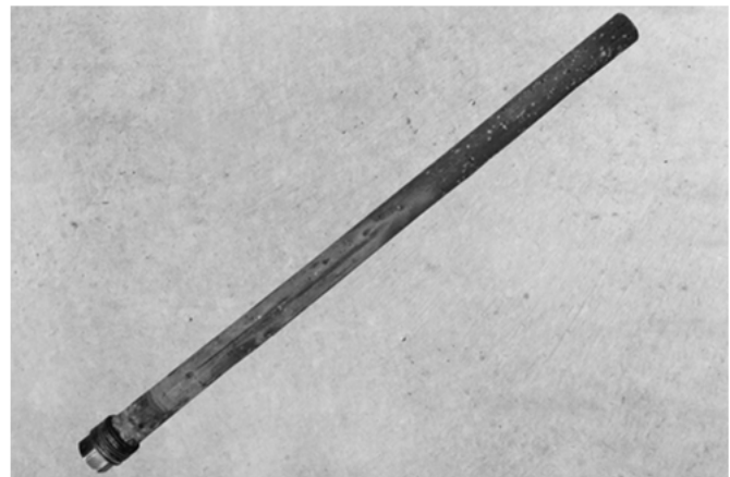
Abb. 87: Magnesium-Schutzanode, Länge 480 mm, Ø 26 mm
