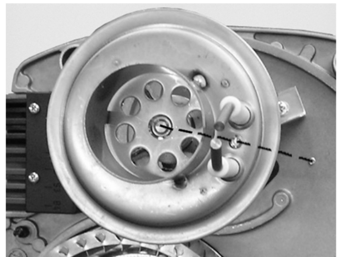
Abb. 40: Mischsystempositionierung und Ausrichtung Zündelektrode
