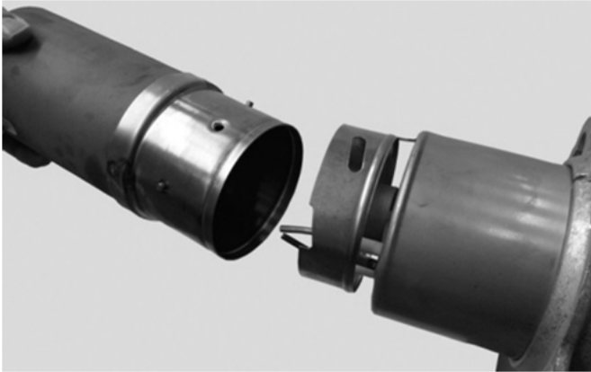
Abb. 3: Montage Keramikrohr auf Stützrohr
