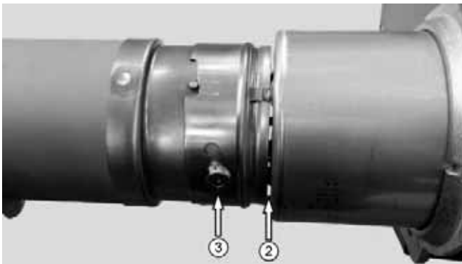
Abb. 4: Einstellung Rezirkulationsmaß R ② (Abbildung beispielhaft)
