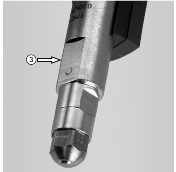
Abb. 39: Heizölvorwärmung mit Passfläche ③ für Verdrehsicherung
