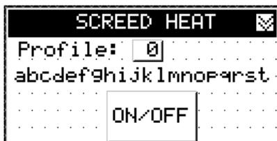
Auf dem Bildschirm "Estrichheizung" kann der Benutzer eines der 11 vorprogrammierten Profile auswählen, je nach Hersteller und Art des verwendeten Estrichs. Wenn das Profil ausgewählt ist, wird der Name des Estrichtyps oder des Herstellers in der Mitte des Bildschirms angezeigt. Bewegen Sie den Mauszeiger über die Schaltfläche "On/Off", um den Vorgang zu starten.
