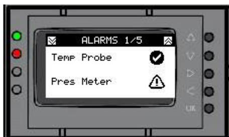
Um schwerwiegende Schäden am EPX-Heizgerät, dem System oder der Installationsumgebung zu vermeiden, kann der EPX-Heizungsregler so eingestellt werden, dass er das Gerät im Falle eines Fehlers überwacht und ausschaltet. Weitere Informationen über die Konfiguration dieser Alarme finden Sie in den Abschnitten "**5.1.2 Sicherheitsfunktionen - Physikalischer und Softwareschutz**" und "**5.4.2 Detaillierte Beschreibung der einzelnen Menüs**".
